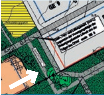
87 Sicherung eines Notwasserweges über GFL Rechte
