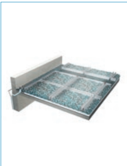
49 Funktionsprinzip eines „blauen Daches“
